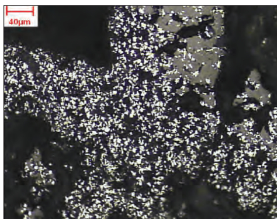
6. ábra A torok és aknafelső modell-kísérlet eredményeként kapott minta metallográfiai csiszolata Fig. 6. Metallographic picture of iron bloom samples from the upper stack level and throat level of the furnace
