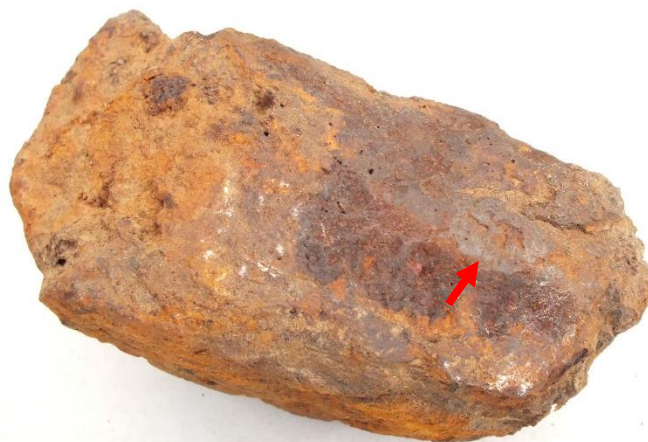
3. Ábra: A pusztakovácsi ékelt vasbucafél vágott (jobbra) és tört (balra) felülete közelről. A p-xrf mérések helye piros nyíllal jelölve.
