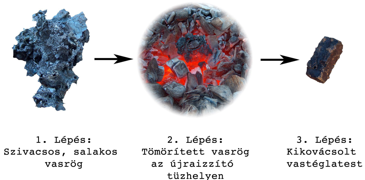
4. ábra: Egy vasbucadarab megmunkálásának lépései
